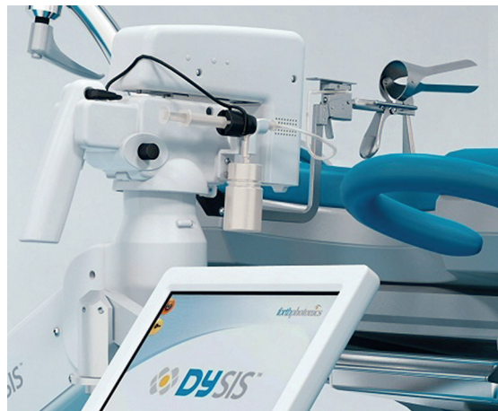
Рис. 53. Оптический модуль DySIS-кольпоскопа [39].
