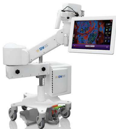
Рис. 52. DySIS-кольпоскоп (Dynamic Spectral Imaging System – динамическая спектральная система отображения; Forth Photonics, Ливингстон, Великобритания) [39].
