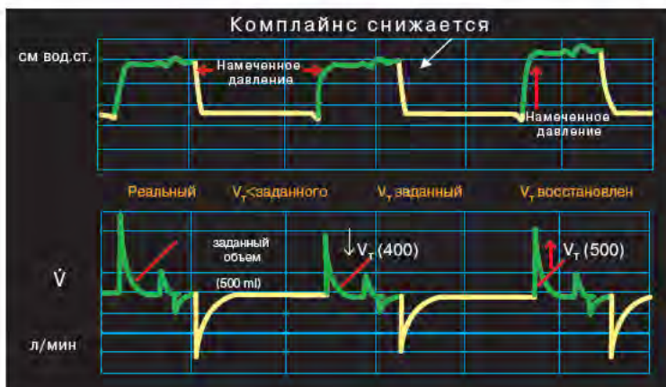
Рис. 13.4. Программа адаптирующегося потока (CMV+), реализованная на аппаратах фирмы «Puritan-Bennett». Теоретические кривые давления (P) и потока ( \dot{V} ) в дыхательных путях. Из инструкции к аппарату «Puritan-Bennett 840».
