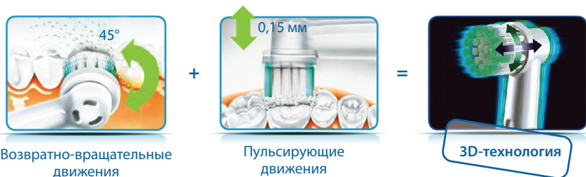
Рис. 97. 3D-технология движения чистящей насадки электрической зубной щетки (по данным компании Braun Oral-B ).
